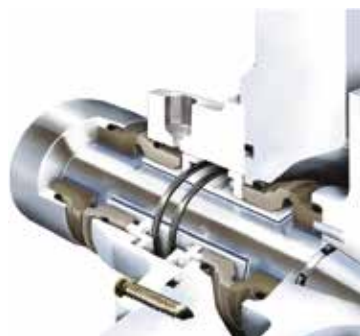
Cierre mecánico doble preparado para refrigeración o barrera de vapor
